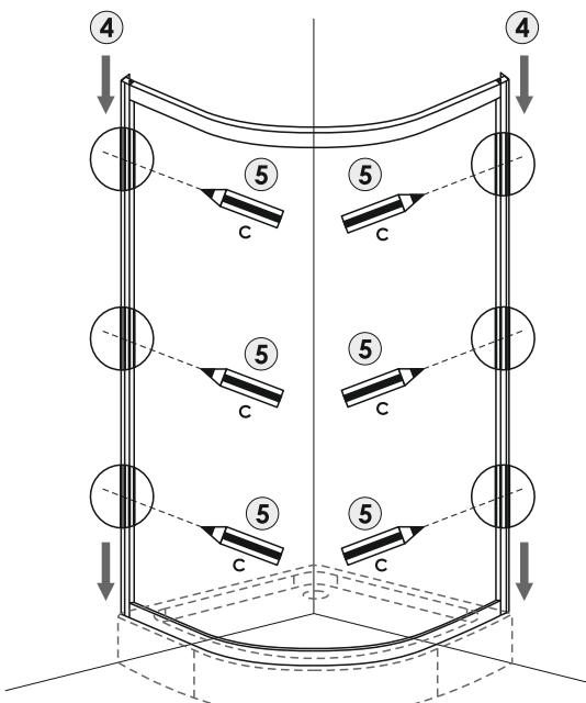
6. Просверлите стены и установочный профиль (рис.6).
